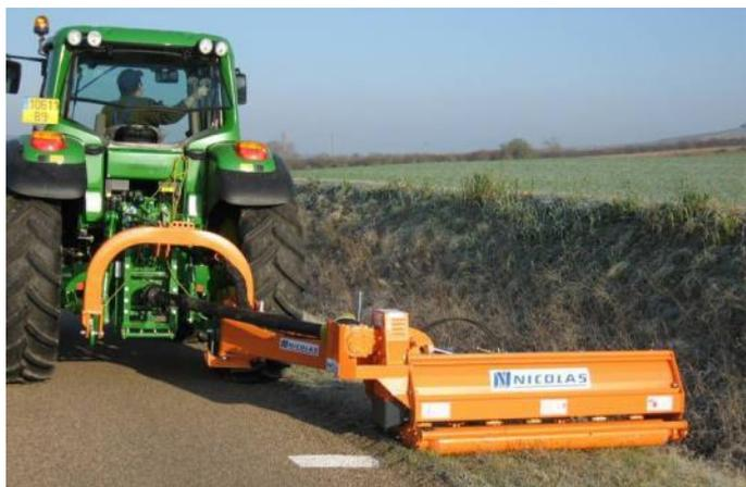
Broyeur à axe horizontal déporté
